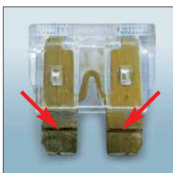
Bild 2: Sicherung mit Oxidstreifen. Fotos: DK7ZB
