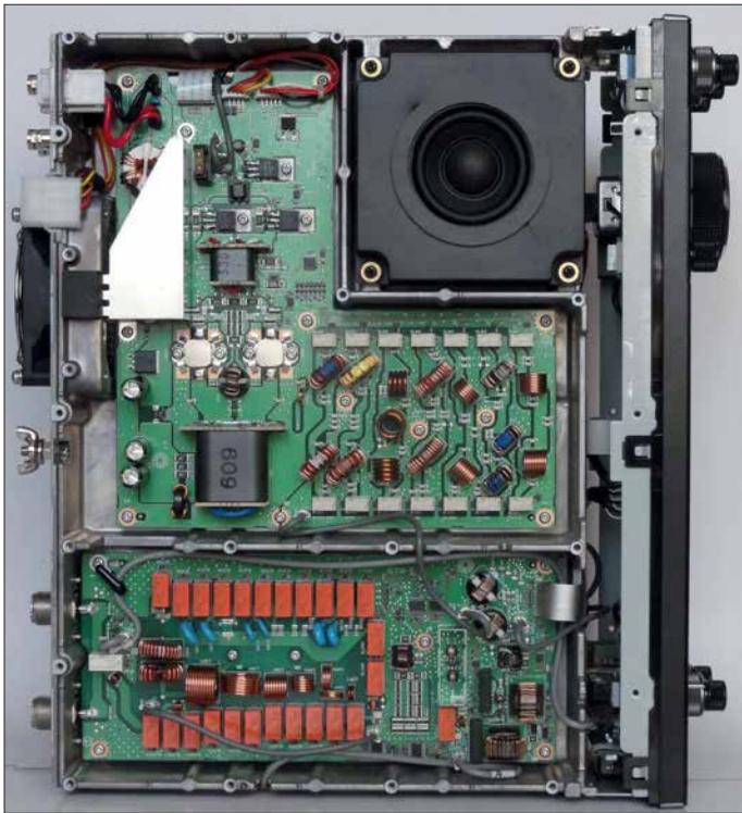
Bild 4: Innenansicht des IC-7610 von unten; die beiden Abschirmboxen enthalten die Digi-Sel-Einheiten, die die Vorselektion der Empfänger besorgen. Unten im Bild die Hauptleiterplatte, darunter unter einer Abschirmung die HF-Einheit
