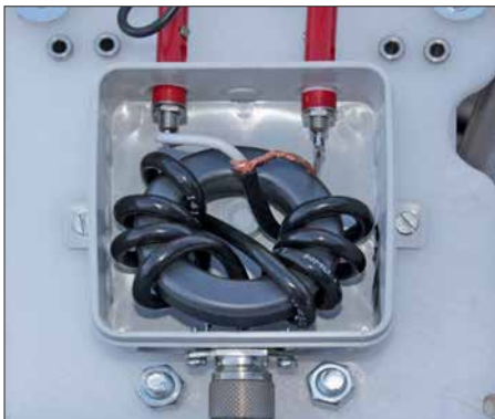
Bild 6: Offene Anschlussdose mit dem Strombalun für die Speisung mit Koaxialkabel
