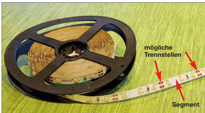
Bild 1: Dieser 5 m lange LED-Streifen mit 300 LEDs besteht aus insgesamt 100 Segmenten, sodass sich der Streifen bei Bedarf an nahezu beliebiger Stelle kürzen lässt.
