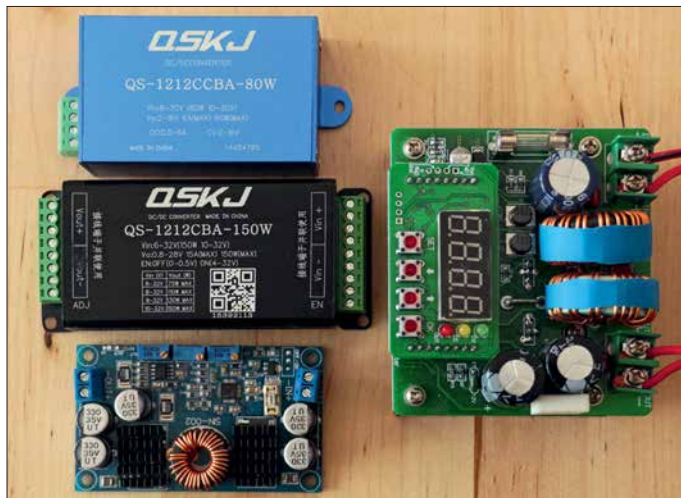
Bild 6: Einige der von uns getesteten Gleichspannungswandler; letztlich eingesetzt wurde der QS-1212 CCBA-80W, der oben links zu sehen und z. B. bei Ebay erhältlich ist.
