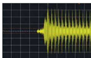
Bild 23: Wie Bild 22, aber nach dem Einschalten; HF-Leistung 20 W PEP
