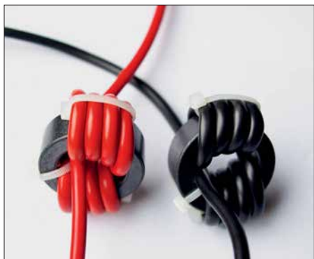
Bild 3: Für die beiden Drosseln auf der Sekundärseite des Schaltnetzteils hat sich das hier gut erkennbare Wickelschema bewährt.
