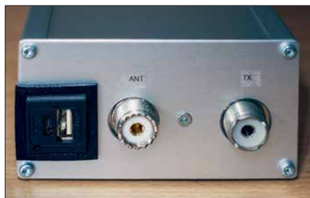
Bild 2: Rückseite des HF-Leistungsmessgeräts mit den Buchsen für Lastwiderstand und Transceiver sowie dem Ladeanschluss für den eingebauten Akkumulator
