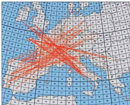
Bei der ersten „richtigen“ 2-m-Sporadic-E des Jahres 2018 entwickelten sich am 28. 5. über Zentralfrankreich Reflexionsgebiete, die QSOs von EA nach DL, G/EI nach I und F nach YU ermöglichten. Grafik: mmonvhf.de
