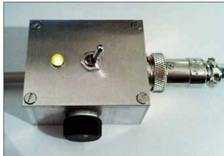
Bild 5: Fertig aufgebaute Abstimmhilfe während des Betriebs; gut zu erkennen sind der PTT-Schalter und der Einstellknopf für die Sendeleistung.
