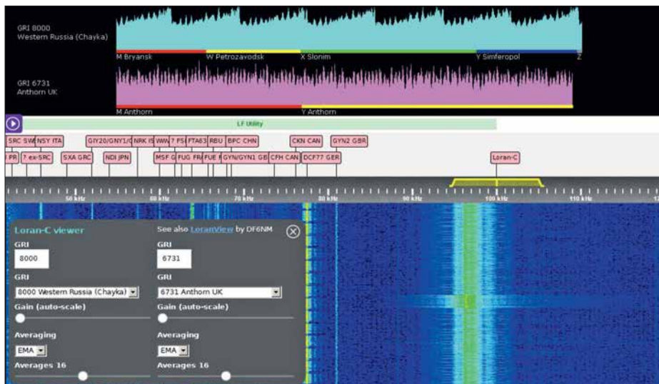
Bild 11: Visualisierung der LORAN- (Long Range Navigation) Signale aus Chayka im Westen Russlands (blau) und aus Anthon, Großbritannien (rot), empfangen auf 100 kHz, Ausschnitt
