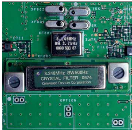
Bild 20: Sicht des Roofing-Filter-Komplexes vom TS-890S ohne das optionale 270 Hz breite Filter (Platz unten); von oben nach unten die Filter mit 15 kHz, 6 kHz, 2,7 kHz und 500 Hz Bandbreite
