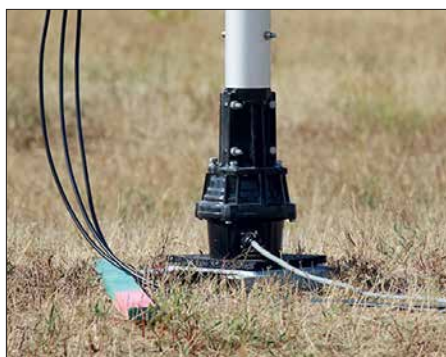
Rotor am Fußpunkt des unten etwa 50 mm dicken Aluminium-Teleskopmasts
