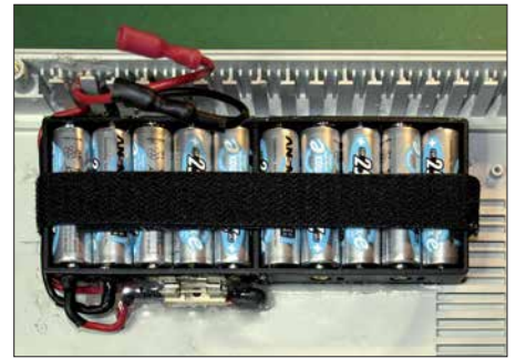
Bild 6: Der Batteriehalter für zehn NiMH-Akkumulatoren ist samt Sicherung im Gehäusedeckel verklebt. Ein durch Schlitze im Halter geführtes Klettband verhindert das Herausfallen der Akkumulatoren.
