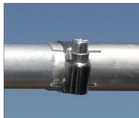
Bild 4: Arretierung der einzelnen Abschnitte mit Schlauchschellen
