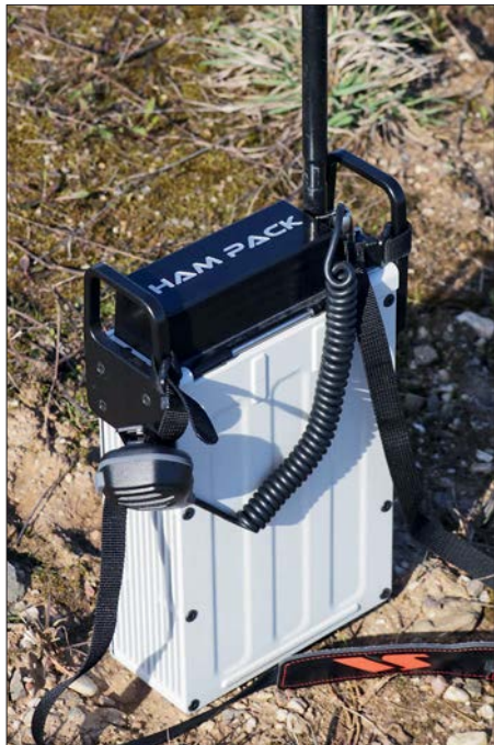
Bild 1: Transportfertiges Ham Pack mit angeschlossenem Mikrofon und aufgesteckter Stabantenne
