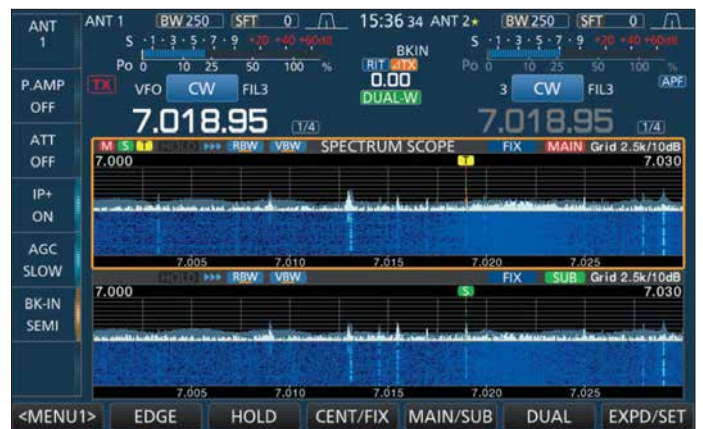
Bild 16: Antennendiversity-Empfang bei synchronisierter Abstimmung und auch sonst mit Ausnahme der Antennen gleichen Einstellungen; einige unterschiedliche Signalpegel sind erkennbar.
