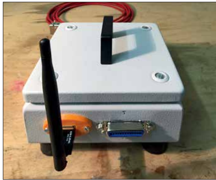
Bild 4: Die abgesetzte Steuerbox des Antennenrotors hat ein Stahlblechgehäuse, das Störstrahlungen wirkungsvoll dämpft.
