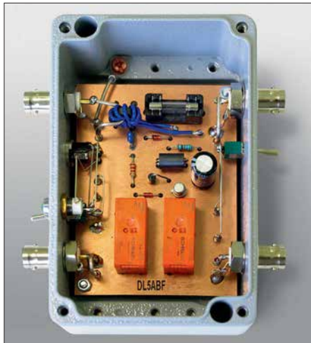
Bild 1: Fertig aufgebauter Antennenumschalter im geöffneten Aluminiumgehäuse
