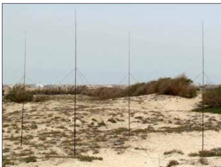
Das 4-Square für 40 m bestand aus vier 12 m hohen Spiderbeam-Glasfasermasten.
