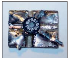
Bild 3: Leiterplattenstück mit vier Löt pads für einen BF981
