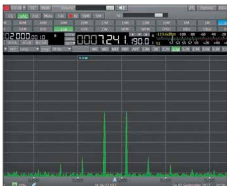
Bild 27: Zweittonmessung am Colibri-Nano; bei P_e = 2 \cdot (-60 \text{ dBm}) ergeben sich \Delta IM_3 = 45 \text{ dB} und IP_3 = -37,5 \text{ dBm} .
