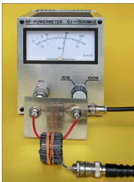
Bild 3: Entwicklungsmuster des Stromübertragers; die beiden Ringkernhälften werden von Gummiringen zusammengehalten.
