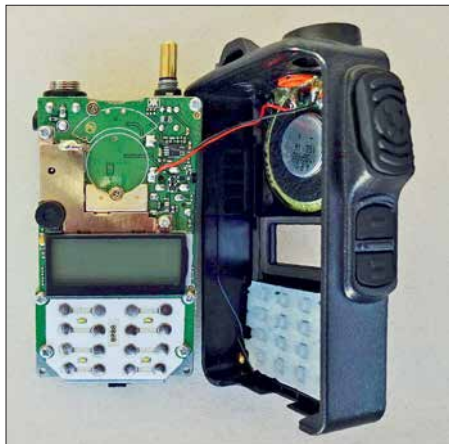
Die Elektronik des als Direktmischer arbeitenden Geräts findet auf einer Platine Platz.
