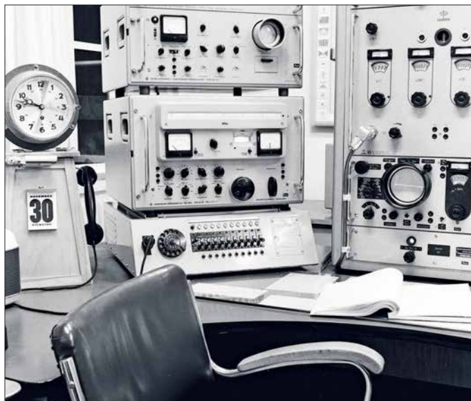
Funkarbeitsplatz mit Rohde & Schwarz EK07 (Bildmitte), Einseitenband-Demodulator NZ 10/2 (oben) und Einwahl-einrichtung in das Telefonnetz (unten). Rechts im Bild (von unten nach oben) Schomandi Netzteil UG1, Oszilloskop und Frequenzdekade Schomandi ND 5; der eigentliche Sender ist nicht im Bild.
