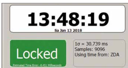
Bild 7: Die Anzeige Locked dokumentiert eine erfolgreiche Auswertung der GPS-Signale (mindestens drei Signale mit kompletter Auswertung). Darunter erscheint die Anzeige der ermittelten Abweichung von 0,451 ms.
