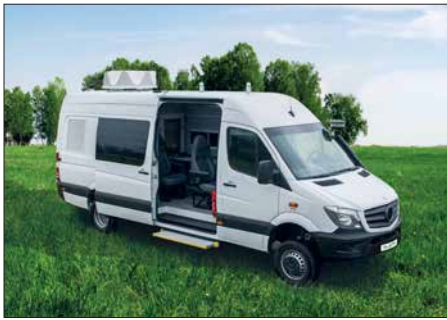
Wellenfänger: Kaum von einem Campingfahrzeug unterscheidet sich dieser Peilwagen mit der Aktiv-Peilantenne DFA2440 für 20 MHz bis 3 GHz auf dem Dach.
