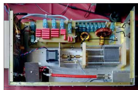
Bild 3: Blick in den von DL4JAL aufgebauten Antennenkoppler nebst Symmetrierbalun nach DG0SA Foto: DL2AVH
