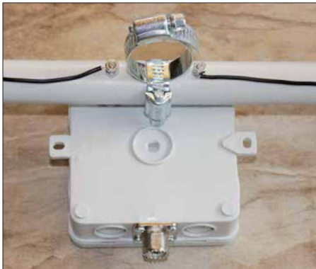
Bild 3: Vorbereitung des Querträgers und der daran montierten Anschlussbox mit zwei Schlauchschellen zur Befestigung am Teleskopmast Fotos: DK7ZB
