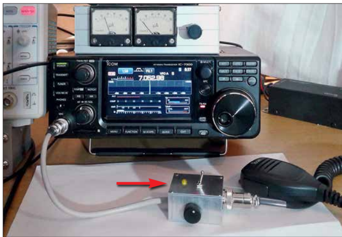
Bild 1: SSB-Abstimmhilfe auf dem Funker-arbeitsplatz; hier wird gerade mit einer Leistung von etwa 100 mW abgestimmt.
