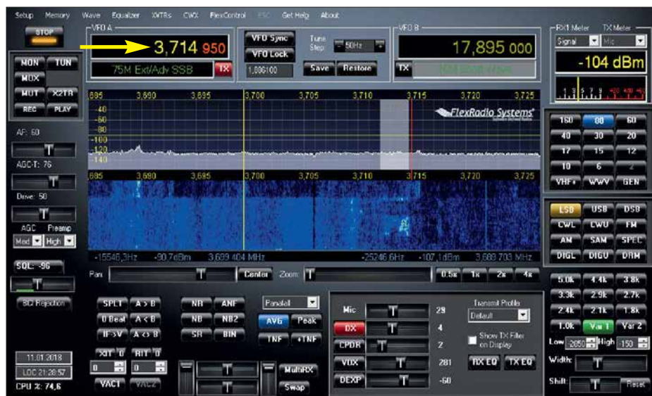
Bild 4: Bedienoberfläche des Flexradio-Transceivers; jede Frequenzänderung bewirkt einen entsprechenden Steuerbefehl in Richtung Antennenkoppler (siehe Bild 5).
