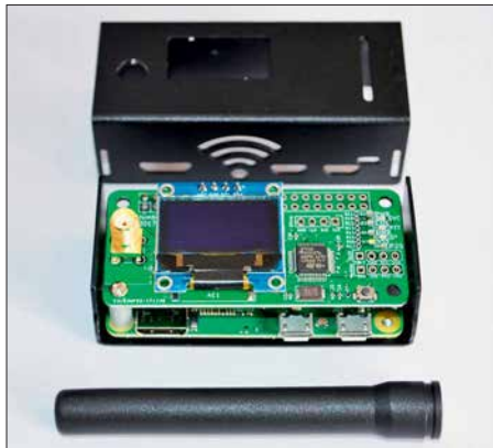
Jumbo-Spot mit Display in einem durch einen 3-D-Drucker erzeugten Kunststoffgehäuse; davor die Aufsteckantenne Werkfoto
