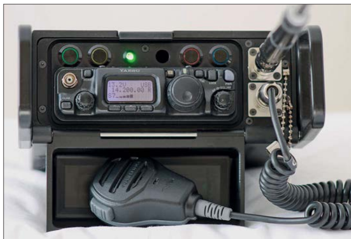
Bild 3: Die Abdeckung für den Yaesu FT-817 dient im aufgeklappten Zustand als Fuß für das Ham Pack.
