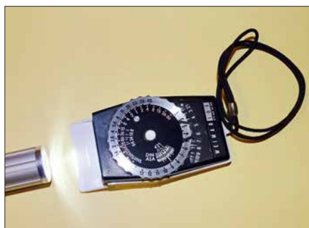
Bild 2: Der alte Belichtungsmesser Weimar Lux Nova erzeugt den Strom durch Minisolarzellen und funktioniert noch immer.
