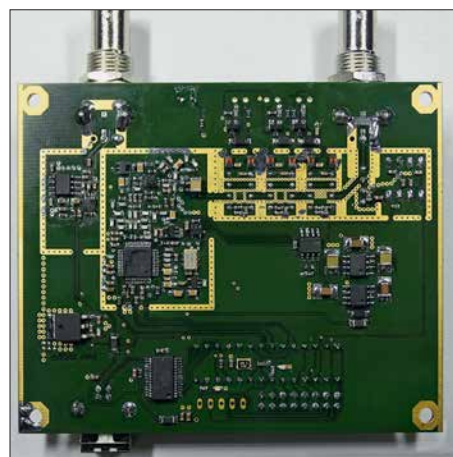
Bild 4: Die meisten Bauelemente des FA-NWT2 haben SMD-Bauform und befinden sich auf der Unterseite der Platine.
