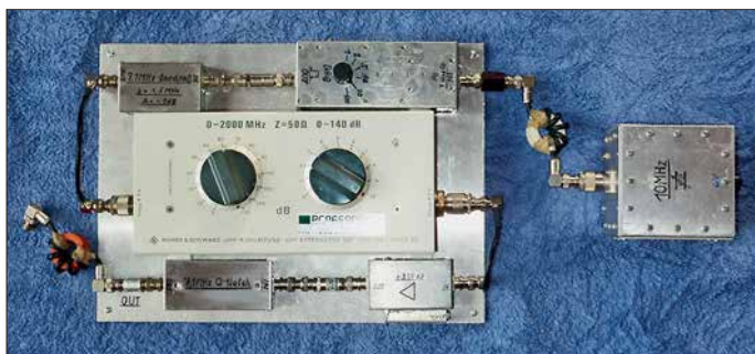
Bild 3: Impulsgenerator mit Vorverstärker und Schmitt-Trigger, Teilerstufe, Teilerschalter und Ausgangsstufe
