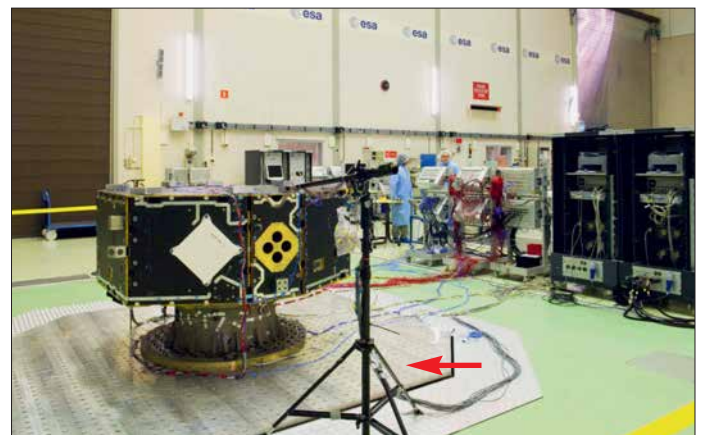
Bild 7: Das STM (engl. structural thermal model ) des LISA Pathfinder ist hier für einen Vibrations­test auf dem Quad Multishaker montiert.
