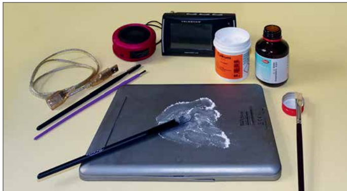
Die Gehäuse und Kabel werden zuerst mit Glycerin gereinigt und anschließend mit Talkum „beschichtet“.
