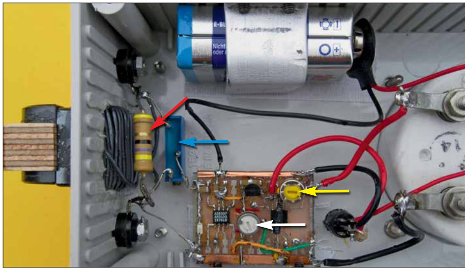
Bild 6: Innenaufbau des Zangenstrommessers mit dem in das Gehäuse hineinragenden Stromkoppler und seinem Abschlusswiderstand (roter Pfeil); die im Text beschriebenen Kalibrierungselemente sind ebenfalls mit farbigen Pfeilen versehen. Fotos: DJ4GC
