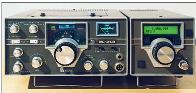
Bild 1: 2-m-Allmode-Transceiver IC-201 mit selbst gebauem externem Digital-VFO
