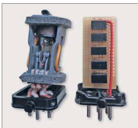
Bild 2: Elektromechanischer Zerhacker und moderne Ersatzbaugruppe
