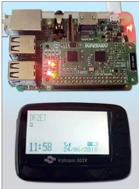
HotSpot MMDVM_HS als Aufsteckplatine für den Raspberry Pi Zero im Zusammenwirken mit einem Pager Fotos: DF2ET
