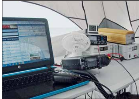
Der Funkplatz unter VK5CE/p von St. Peter, OC-220. Ein Ventilator senkte die Temperatur im Transceiver.
