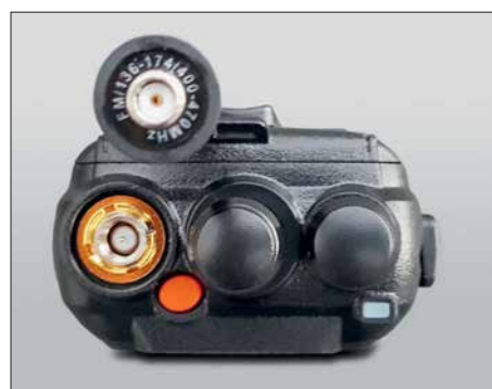
Reverse-SMA wie gewohnt: Der Antennenanschluss ist ein Stecker und die Antenne, hier von unten gezeigt, besitzt eine Buchse.
