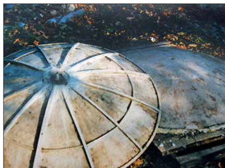
Bild 4: 1,5-m-Spiegel mit eingeklebten Aluminiumprofilen, rechts die Gipsform
