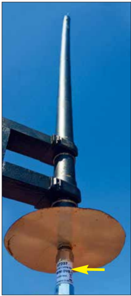
Bild 4: Selbst gebaute 8-Element-Collinear-Antenne für den ADS-B-Empfang auf 1,09 GHz; der TV-Sat-Vorverstärker befindet sich direkt am Fußpunkt (Pfeil)
