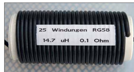
Bild 2: Koaxial-Balun auf einem 50-mm-Installationsrohr
