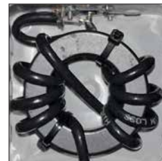
Bild 4: Strombalun mit zweimal 4 Wdg. Aircell5 auf einem FT240-43 Fotos: DK7ZB
