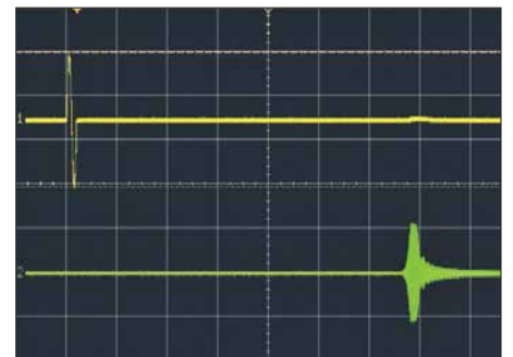
Bild 27: Oszillografische Ermittlung der Sendelatenz; zwischen wide , mid und nar ändert sich nur die Breite des grünen Ausgangsimpulses ein wenig. Screenshots: DJ1TO
