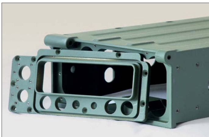
Bild 5: Das Ham-Pack-Gehäuse besteht insgesamt aus drei gefrästen und pulverbeschichteten Aluminiumteilen. Die als Schutz für den Transceiver dienende Abdeckung ist hier nicht zu sehen, nur in den Bildern 3 und 4.
