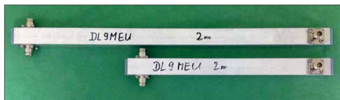
Bild 1: Der übliche \lambda/4 -Splitter (oben) ist bei 2 m rund 20 cm länger als der modifizierte Bramham-Koppler unten.
