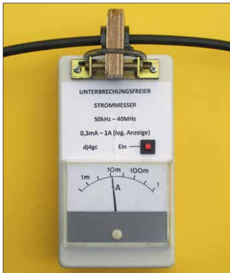
Bild 1. Vollständig aufgebauter Zangenstrommesser in Betrieb: Auf dem Kabelmantel des Aircell7 fließen etwa 12 mA.
