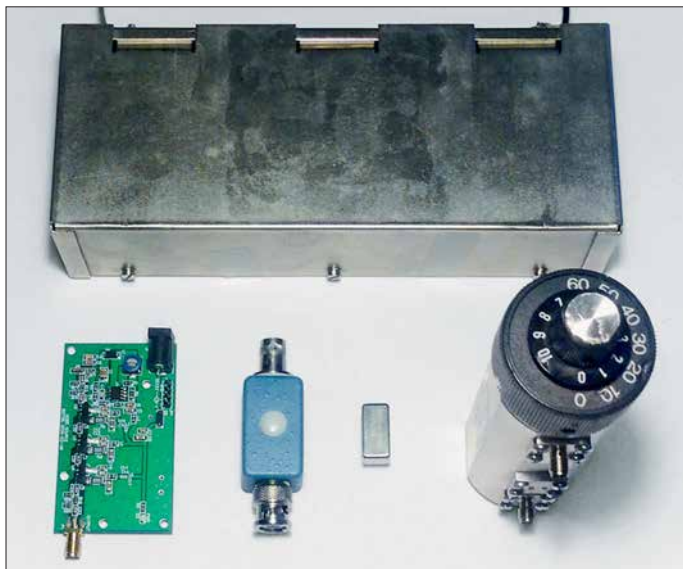
Bild 31: Für die Messbeispiele verwendete Teile des NPR-Messplatzes; oben: Siemens-Bandsperrung 2,4 MHz mit neun Schwingkreisen für Innerbandmessungen, unten, v. l. n. r.: Rauschgenerator, Anpassglied mit 1-MHz-Hochpass-, 6-MHz-Tiefpassfilter, einstellbares Dämpfungsglied 0 dB bis 70 dB
