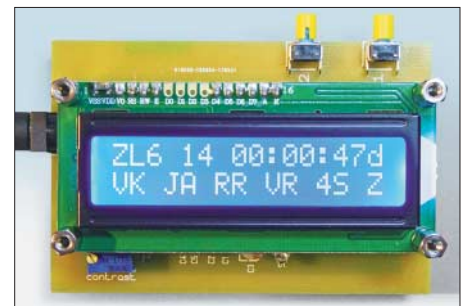
Bild 6: Das aufgesteckte LC-Display ist wahlweise mit blauer oder grüner Hintergrundbeleuchtung erhältlich.
