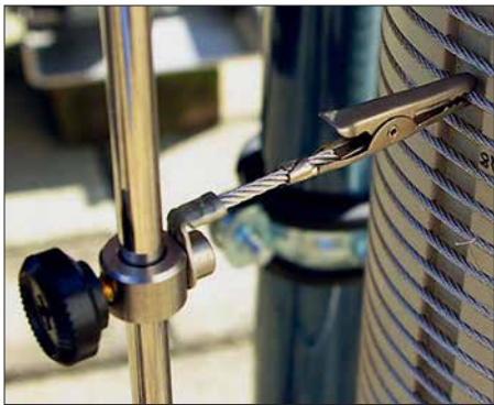
Bild 3: Ausführung des Spulenabgriffs mit Feststellschraube und Krokodilklemme
