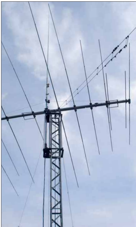
Bild 1: Befestigung zweier spannungsgekoppelter Sloper am Metalltragemast eines KW-Beams Foto: DK6ED
