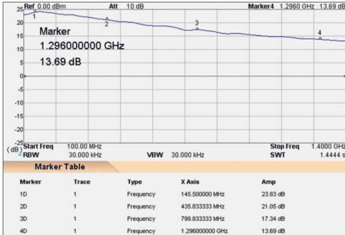
Bild 4: Frequenzgang des Verstärkers einschließlich abgeglichener Vorkreis
