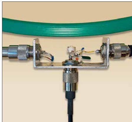
Bild 2: Das austauschbare Anpassglied der Loop-Antenne, hier ohne Blechabdeckung; zur Aufnahme der drei SO239-Buchsen und des Anpassglieds dient ein U-förmig gebogener Streifen (140 mm x 30 mm) aus 2 mm dickem Aluminiumblech.
