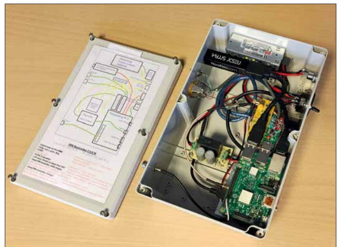
Bild 9: Mobile Empfängerbox, ausgestattet mit Raspberry Pi3, Soundkarte, zwei DVB-T-Sticks, Spyverter, Schaltenteil und Step-Down-Konverter; alle Anschlüsse sind von außen erreichbar.
