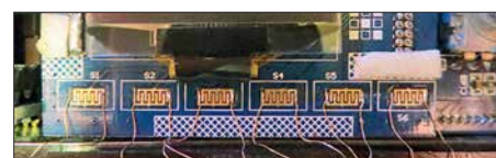
Schritt 1: Dünne Kupferdrähte an die Kontaktkämme löten.
