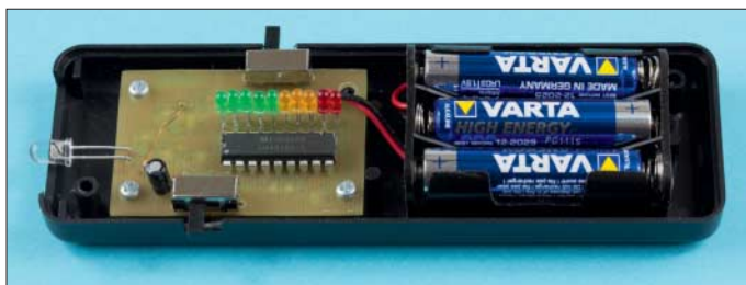
Bild 1: Detektor für moduliertes Licht mit geöffnetem Gehäuse Foto: Red. FA
