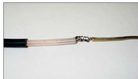
Bild 5: Übergang Antennenlitze – Koaxialkondensator; hier vor dem Überziehen mit Schrumpfschlauch
