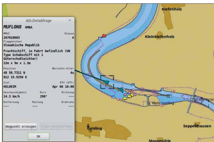
Bild 2: Kartenausschnitt der Software OpenCPN mit dem Schiffsverkehr am 6. 4. 2018 um 1000 UTC am Donauwehr Geisling; im Detailfenster sind die Daten eines unter slowakischer Flagge fahrenden Frachtschiffs zu sehen.
