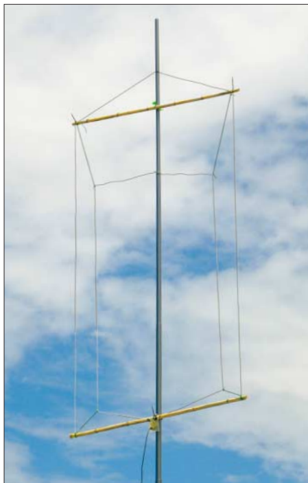
Bild 1: Fertige Zweiband-Oblong-Antenne für 50 MHz und 70 MHz im Einsatz
