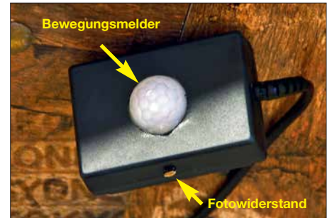
Bild 9: Gehäuse mit Bewegungsmelder und Fotowiderstand PW1 unterhalb einer Holzleiste, auf der der LED-Streifen liegt
