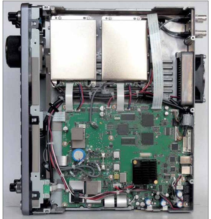
Bild 4: Innenansicht des IC-7610 von unten; die beiden Abschirmboxen enthalten die Digi-Sel-Einheiten, die die Vorselektion der Empfänger besorgen. Unten im Bild die Hauptleiterplatte, darunter unter einer Abschirmung die HF-Einheit
