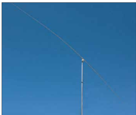
Bild 1: Fertig aufgebauter Portabeldipol beim Einsatz im 20-m-Band
