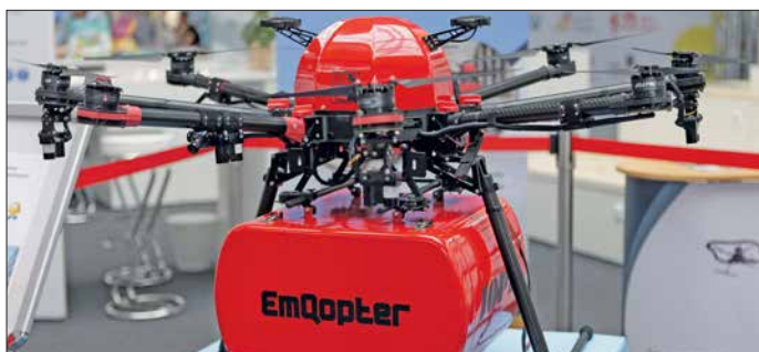
Die autonome Lieferdrohne von EmQopter transportiert Lasten bis 2 kg.
