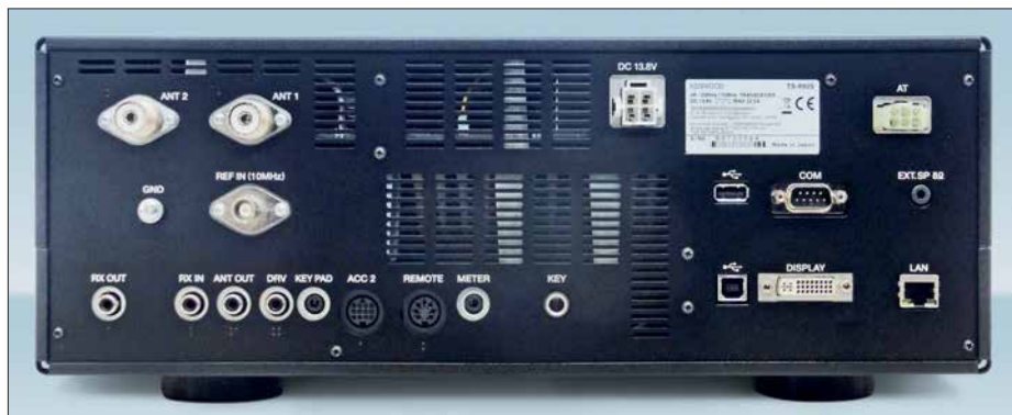
Bild 2: Auf der Rückseite des TS-890S befindet sich u. a. ein LAN-Anschluss, über den sich das Gerät ohne einen PC am Aufstellungsort über das Internet steuern lässt.
