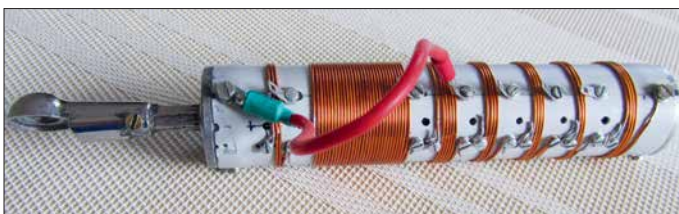
Bild 9: Komplett aufgebaute Verlängerungsschraube einschließlich DV-Anschluss und „Wanderleitung“
