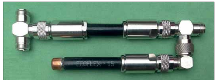
Bild 15: Fertiger Stichelungs-transformator für das 2-m-Band Screenshots und Foto: DH2MIC
