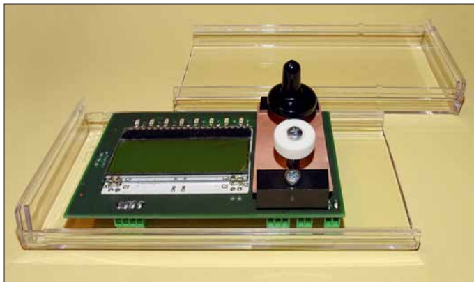
Bild 1: Diese Baugruppe mit Anzeige ermöglicht die Veranschaulichung der Bedienung durch Magnetfeldsensoren. Sie lässt sich zu einem universell nutzbaren Gerät erweitern.
