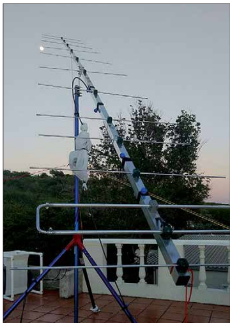
12er-Yagi, Tripod auf den Dachgarten – und fertig ist die EME-Antenne bei PJ2T.
