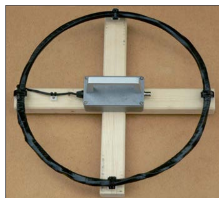
Bild 17: Einzelsuchspule mit Kondensatorabstimmung und Ringkernübertrager im Metallgehäuse Fotos: DG9WF
