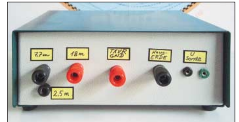
Bild 6: ... und Rückseite mit den Anschlüssen für Transceiver, Erde und Radials
