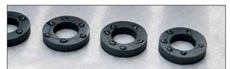
Bild 6: Vorbereitung zum Aufkleben – Ringkerne mit einigen Klebertropfen
