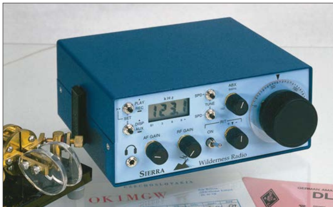
Bild 1: Frontansicht des Transceivers mit der Zusatzbaugruppe digitale Frequenzanzeige/elektronische Taste (für verschiedene Aufrüstungsgrade stehen unterschiedliche Frontplatten zur Verfügung).
