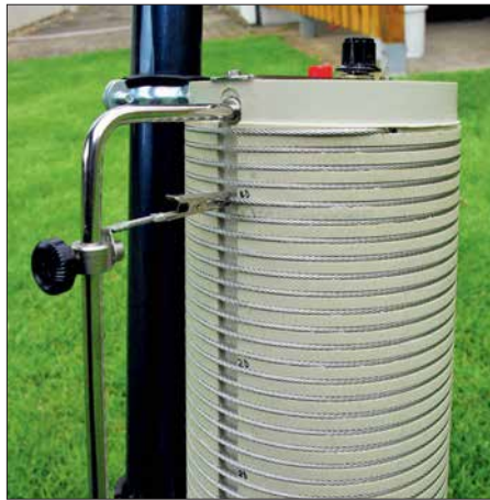
Bild 5: Spulenkörper mit gefräster Führung für die Drahtwindungen und Längsschlitz
