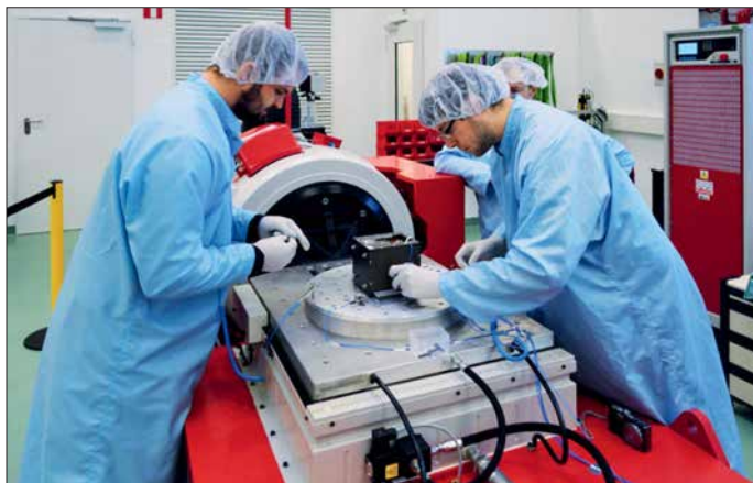
Bild 7: Das STM (engl. structural thermal model ) des LISA Pathfinder ist hier für einen Vibrations­test auf dem Quad Multishaker montiert.
