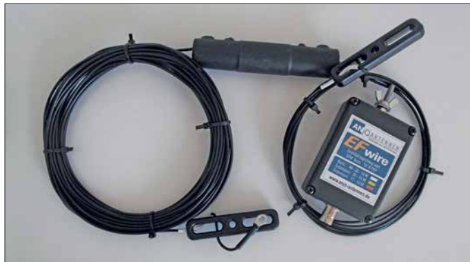
Bild 1: Komplette Antenne EFW levis mit Übertragergehäuse, Verlängerungsspule und Isolatoren; die oben in der Mitte sichtbare Verlängerungsspule ist durch Schrumpfschlauch vor Witterungseinflüssen geschützt.
