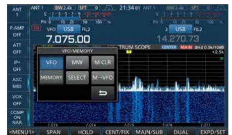
Bild 10: Der Umgang mit den Speicherkanälen gelingt nur über die Quick-Taste und dieses beim IC-7610 nun relativ kleine Menü.
