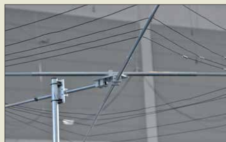
Die nur 2,78 m breite Cobweb-Antenne von EAntennas, praktisch ein mehrfach abgewinkelter Fächerdipol, strahlt auf den fünf KW-Bändern von 20 m bis 10 m omnidirektional.
