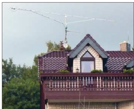
DJ6AG arbeitete EA8TX mit einer 13-Element-Yagi-Antenne, die eine Boom-Länge von 8 m hat. Die Leistung betrug 500 W. Beide QTHs der Funkpartner liegen in Hanglage und verfügen über einen weiten Blick in die jeweilige Richtung zueinander. Foto: DJ6AG
