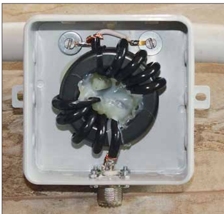
Bild 4: Strombalun aus 2 x 4 Wdg. Aircell 5 auf einem FT240-43 in der Anschlussbox; die Kontaktierung des Strahlers erfolgt über lange, durch den Querträger führende Schrauben.
