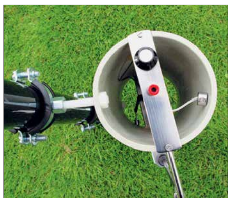
Bild 8: Oberer Teil der Spule mit Antennen- drahtanschluss und Drehkondensatorknopf
