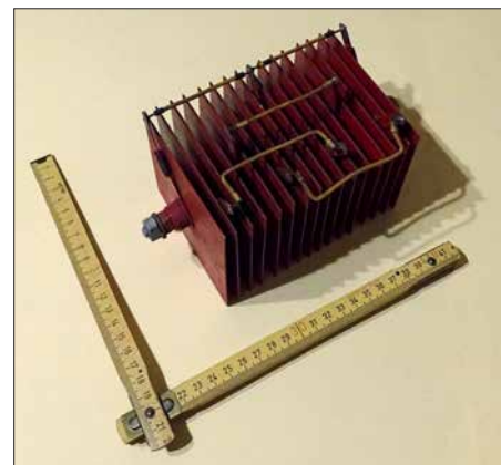
Bild 5: Selengleichrichter bestehen aus gestapelten, mit Selen beschichteten Platten. Diese große Version ist bereits werksseitig als Brückengleichrichter verdrahtet.
