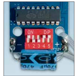
Bild 10: Leiterplatte der Fernbedienung, bei der die Batterie samt Halter entfernt und durch einen 470-µF-Kondensator ersetzt wurde
