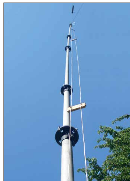
Bild 2: Strahlungsgekoppelte Zweiband-L-Antenne von DK6ED, hier an einem stabilen GFK-Mast und mit einer Zweidrahtleitung, die die vertikalen Abschnitte der beiden „L“ bildet Foto: DK6ED
