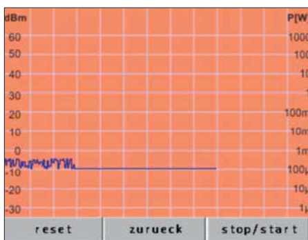
Bild 4: Die Langzeitmessung lässt sich nach dem Aufruf der zweiten Displayseite durch Antippen des Buttons stop/start aktivieren.
