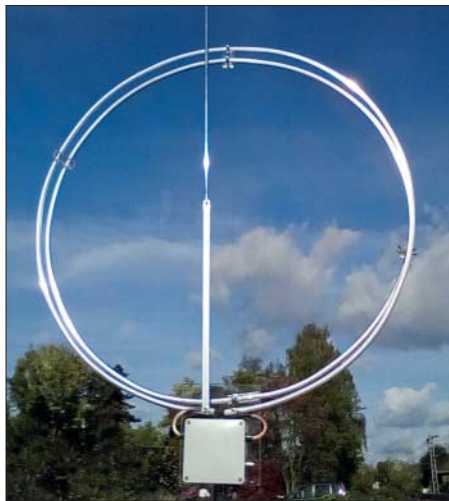
Bild 1: Praktisch ausgeführte Antenne für 40 m und 80 m mit 2-Windungs-Loop und 1,8 m langem E-Feld-Strahler Foto: DL4KCJ
