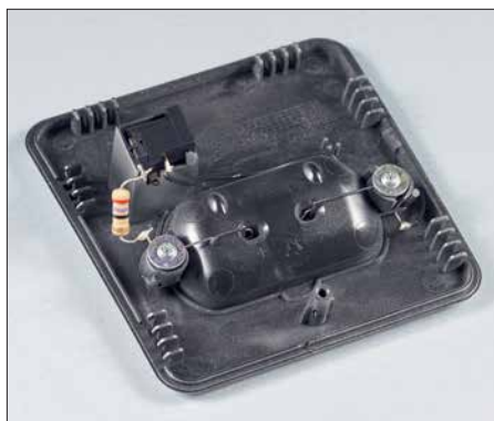
Bild 31: Diese Ladeschale enthält lediglich einen Vorwiderstand zur Begrenzung des Ladestroms. Das minimiert die Herstellungskosten, aber auch die Lebensdauer des Akkumulators.
