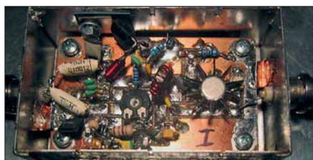
Bild 4: Praktischer Aufbau des hochlinearen Leistungsverstärkers ( V_p = 31 dB); zum Einsatz kamen Transistoren vom Typ 2N5119 und VN89AF.
