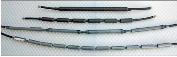
Bild 4: Kabelstücke mit aufgeschobenen und eingeschrumpften Ferrithülsen
