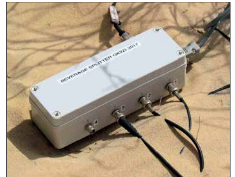
Der Beverage-Splitter von OK2ZI schaltete unsere drei Beverage-Antennen auf 160 m.
