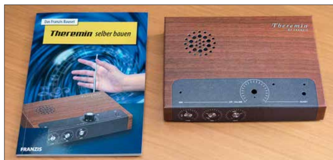
Theremin-Bausatz mit Anleitung; der Pappkarton dient später als Gehäuse.
