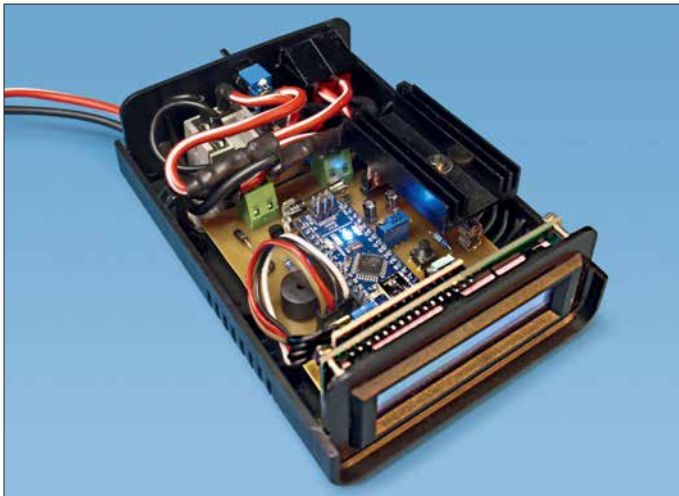
Bild 1: Innenansicht des Musters des Überwachungsgeräts in einem Kunststoffgehäuse; der Kühlkörper für den Spannungsregler muss nahe den Lüftungsschlitzen in Deckel und Boden liegen.
