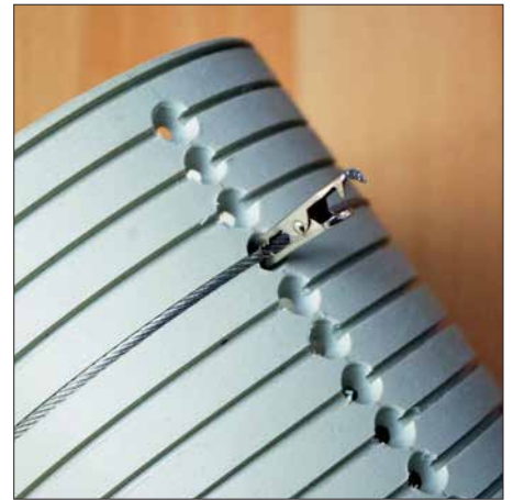
Bild 6: Alternative zum Längsschlitz in Form von Zentrierbohrungen für die Abgriffe
