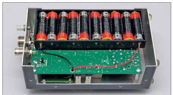
Bild 20: Das Impedanzmessgerät MFJ-259B wird mit zehn Mignon-Zellen betrieben, wobei wahlweise Akkumulatoren mit 1,2 V Nennspannung als auch Alkali-Batterien mit 1,5 V einsetzbar sind. Fotos: DJ3TZ
