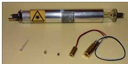
Bild 8: Unter einer alten Helium-Neon-Laseröhre liegen hier zwei Laserdiodenmodule (rechts) und einzelne Laserdioden (links).
