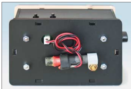
Bild 2: Auf der Rückseite des Gehäuses ist die Ferritantenne befestigt, die sich auch abnehmen und abgesetzt betreiben lässt.
