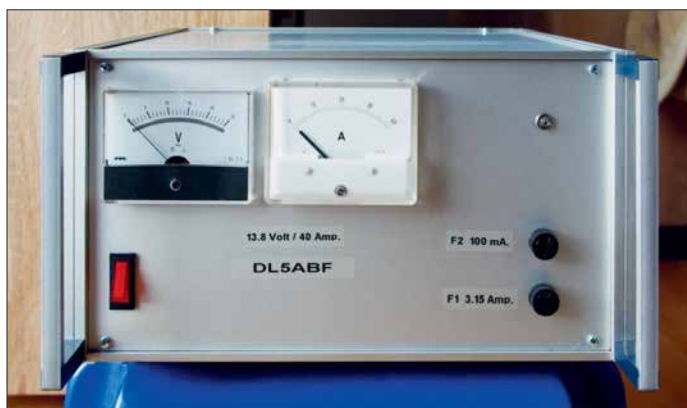
Bild 1: Frontansicht des 12-V-Stromversorgungsgeräts, das bis zu 40 A liefern kann. Im Metallgehäuse ist ein leistungsfähiges, entstörtes Schaltnetzteil untergebracht.
