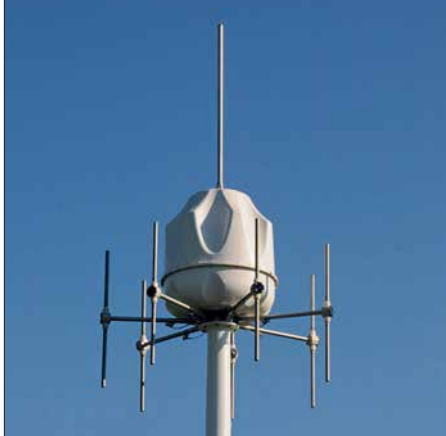
Rundblick: 21 Antennenelemente peilen Sender von 500 kHz bis 3 GHz auf besser als 1,5^\circ genau. 55 kg wiegt dieser Mobilpeiler.
