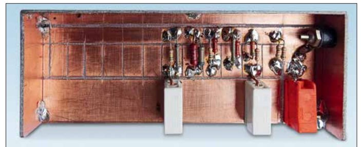
Bild 2: Die Widerstände lassen sich direkt auf die breiten Leiterbahnen löten.
