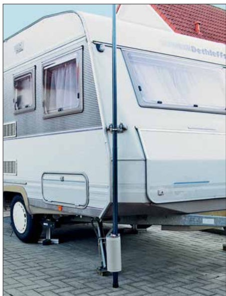
Bild 1: Betriebsbereite KW-Allbandantenne; am unteren Ende ist die Anpassungsspule gut zu erkennen.
