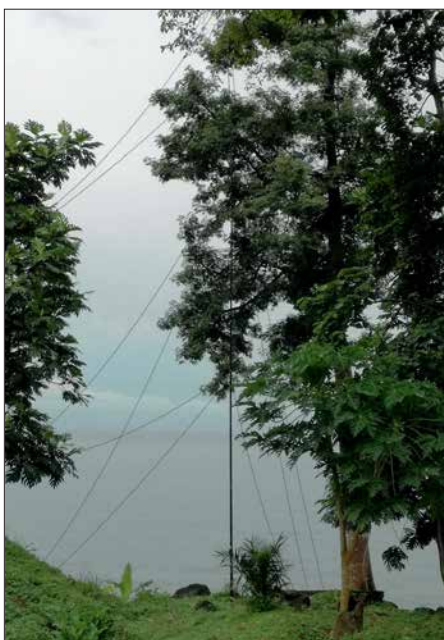
Als Standort für unsere RA6LBS-Vertikalantenne (30 m bis 160 m) nutzten wir eine Lücke zwischen den Bäumen.
