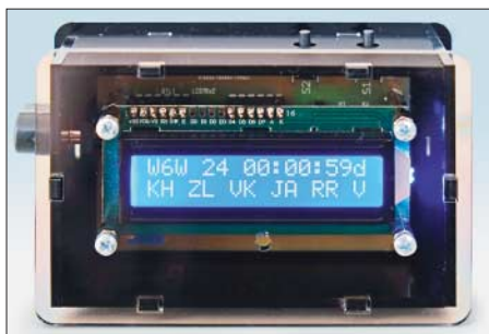
Bild 1: Die Frontseite des Gehäuses ist mit einer durchsichtigen Plexiglasscheibe abgedeckt. Fotos: DF1SD
