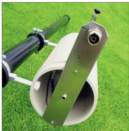
Bild 7: Unterer Teil der Antenne mit Koaxial-Steckverbinder und Erdungsbuchse
