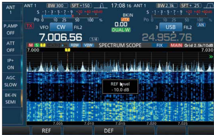
Bild 16: Antennendiversity-Empfang bei synchronisierter Abstimmung und auch sonst mit Ausnahme der Antennen gleichen Einstellungen; einige unterschiedliche Signalpegel sind erkennbar.
