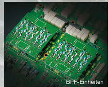
Zwei unabhängige, völlig gleichwertige Empfänger
