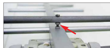
Bild 8: Befestigung des Schleifendipols auf der Oberseite des Trägers
