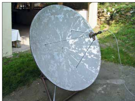
Bild 5: Satellitenempfangsanlage mit 1,5-m-Spiegel und aufgesetztem Empfangsmodul
