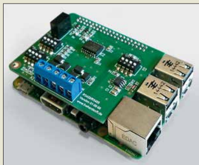
Die Schnittstellenanschlüsse des RS422/RS485-Shields sind auf Klemmleisten zugänglich.
