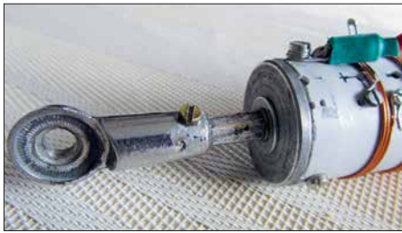
Bild 8: Der DV-Anschluss ist in das Aluminiumdrehteil an der Unterseite der Verlängerungsschraube gesichert.
