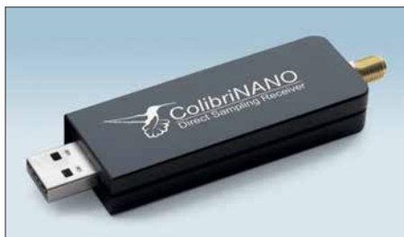
Bild 1: Colibri-Nano – ein vollwertiger DDC-SDR im gefrästen Aluminiumgehäuse, nicht größer als ein USB-Stick
