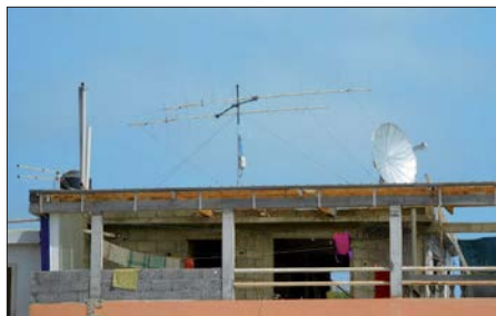
Die 2 × 8-Element-Gruppe von Hermann und Peter als D44TVG: Man kann auch mit deutlich weniger Aufwand als beispielsweise bei 3DA0MB erfolgreich via Mond funken.
