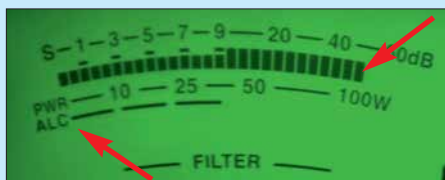
Bild 7: So muss es sein; die Maximalleistung geht eine Winzigkeit zurück und die ALC spricht nicht mehr an. Foto: DL2RD
