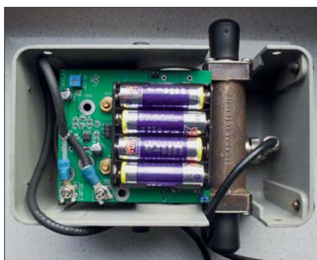
Bild 6: Das Interface FX743 wird direkt ins Wattmeter eingesetzt und dort verkabelt.
