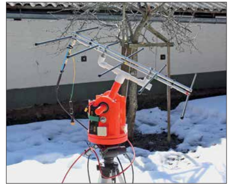
Bild 5: Portabelrotor im praktischen Einsatz; hier ist er auf ein Stativ montiert und bewegt die angebaute Antenne.
