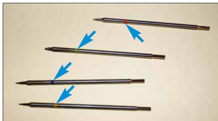
Bild 2: Die Lötspitzen einer Lötstation nach dem Induktionsverfahren sind abhängig von der Löttemperatur farblich gekennzeichnet.
