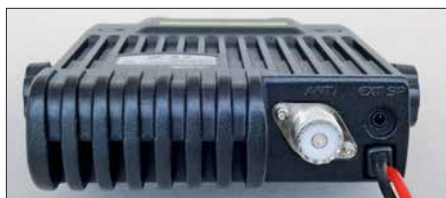
Eine SO239-Buchse dient als Antennenanschluss.
