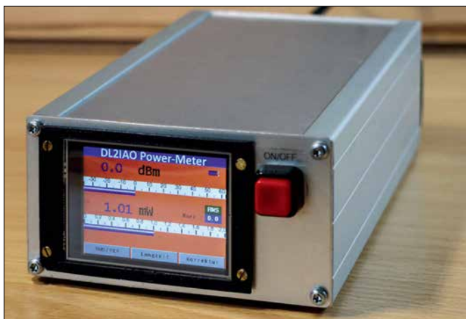
Bild 1: Selbst gebautes HF-Wattmeter mit Nextion-Grafikdisplay; abgesehen vom Hauptschalter gibt es keine weiteren mechanischen Bedienelemente, da alle Eingabefunktionen über das Touch-Display realisiert werden.
