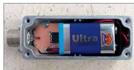
Bild 4: Platine und 9-V-Batterie des passiven Senders passen in ein kleines robustes Aluminium-Druckgussgehäuse.
