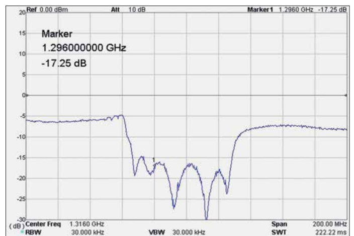
Bild 8: Weitabselektion des Verstärkers im Frequenzbereich von 50 MHz bis 1,5 GHz
