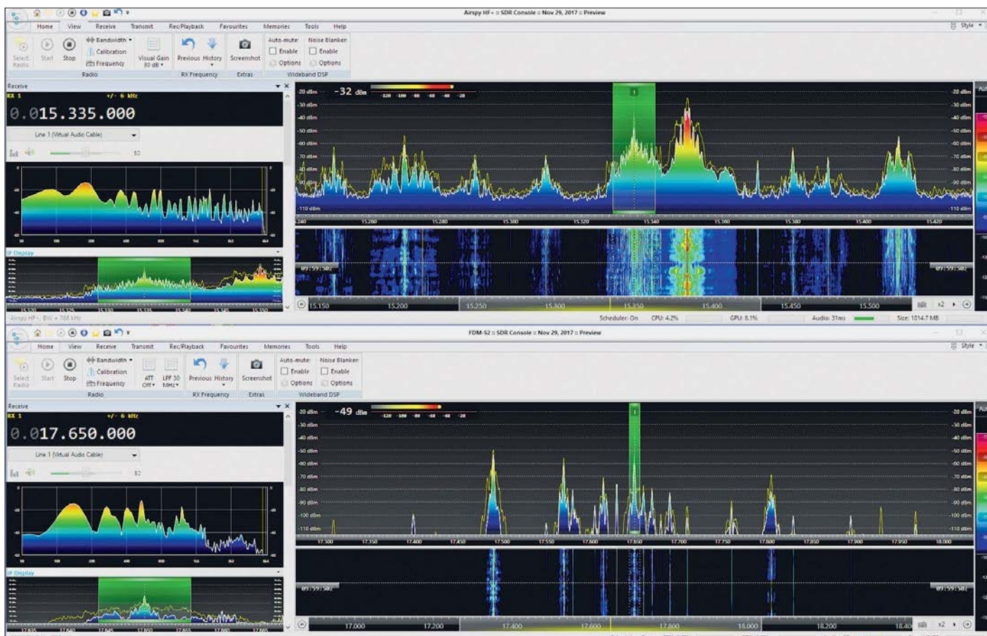
Bild 8: SDR Console V3 lässt sich in mehreren Instanzen öffnen, sodass eine Vielzahl von SDRs gleichzeitig betrieben werden kann – hier ein Airspy HF+ (oben) im 19-m-Rundfunkband und ein Elad FDM-S2 (unten) im 16-m-Rundfunkband.
