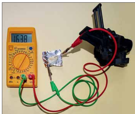
Bild 3: Bei diesem Experiment lässt sich saurer geschnittener Knoblauch auf einer Aluminiumfolie als Gleichrichter verwenden.
