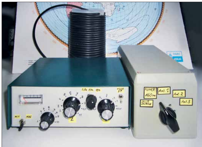
Bild 1: Bewährte Mittel zur Unterdrückung vagabundierender Hochfrequenz im Shack: Mantelstromsperre (hier eine Luftspule aus aufgewickeltem Koaxialkabel), Erdkoppler und Antennenschalter mit Abschaltung der aktuell nicht benutzten Antennen
