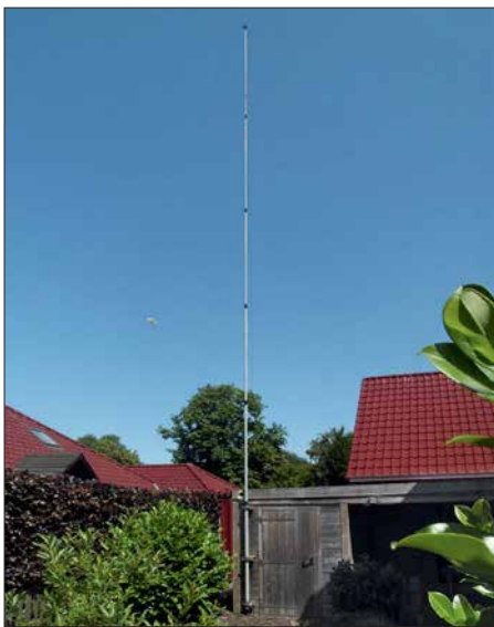
Bild 2: Dank 12 m Länge eignet sich die EFW levis als Vertikalstrahler an einem GFK-Mast.
