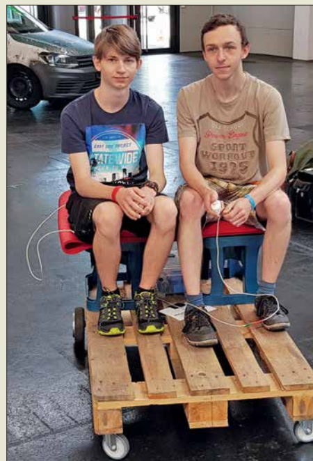
Zwei Jugendliche hatten sich eine Europalette zum E-Car umgebaut. Als Sitze fungieren zwei Bierkisten. Zur Steuerung dient eine Art Joystick in Größe einer Maus.
