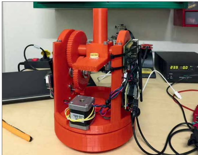
Bild 1: Prototyp des selbst gebauten Antennenrotors aus 3-D-Druckteilen mit angebauten Schrittmotoren
