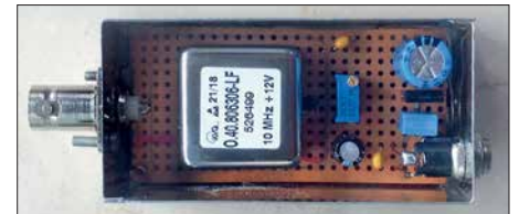
Bild 6: 10-MHz-Referenzoszillator auf einer Universalleiterplatte im Weißblechgehäuse
