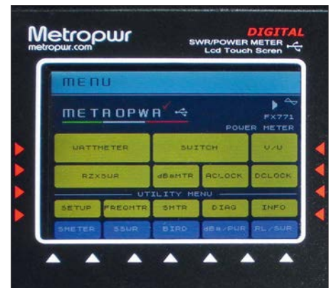
Bild 2: Die Steuerung des gesamten Mess- und Umschaltsystems ist auch über das Menü des FX771 möglich.
