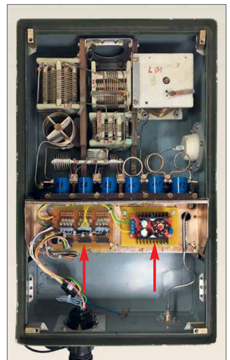
Bild 3: Modifizierter Koppler AAG100 mit abgeschraubtem Gehäusedeckel; links der neue Leistungsteil der Steuerbaugruppe, rechts die Relaisstromversorgung
