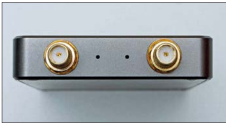
Bild 3: Für den Anschluss von HF- und VHF-Antennen ist je ein SMA-Anschluss vorgesehen, dessen Aktivität verschiedenfarbige LEDs signalisieren.
