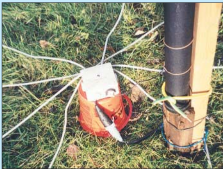
Bild 18: Experiment Groundplane-Antenne mit erdauffliegenden Radials: acht – wie hier gezeigt – sind definitiv zu wenig, 15 oder mehr sind anzustreben. Foto: Red. FA
