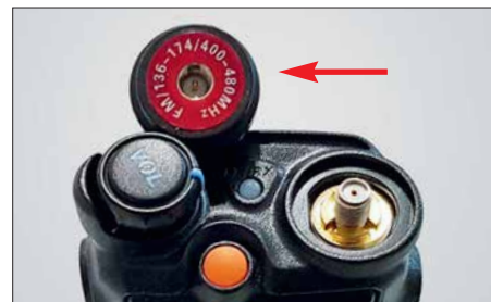
Bild 2: Oberseite mit SMA-Buchse, links oben die von unten gesehene Duobandantenne
