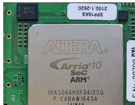
Bit für Bit: Ein leistungsstarker FPGA ist die Steuerzentrale der SDRs von Plath.
