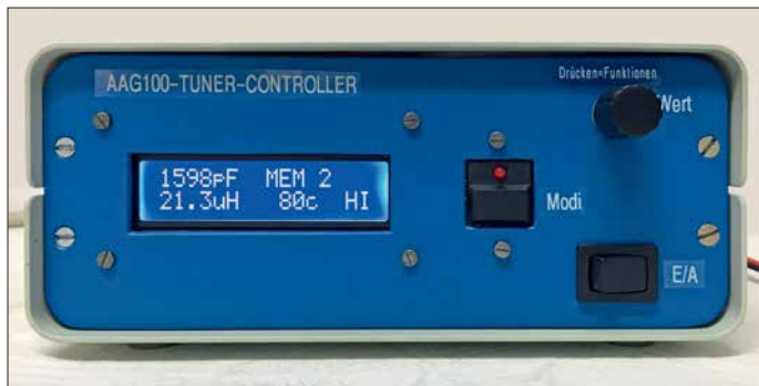
Bild 1: Frontansicht des selbst gebauten, Bedienteils zur Steuerung des Antennenkopplers AAG100
