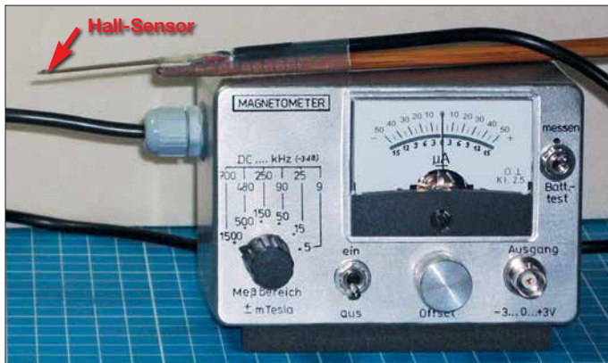
Bild 1: Das Messgerät ist in ein Aluminiumgehäuse mit 120 mm x 79 mm x 58 mm eingebaut und wird von einer 9-V-Batterie versorgt. Fotos: Franke
