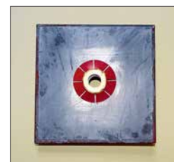
Bild 4: In der Mitte der Platte muss für die Kontaktfeder die Zinnschicht über dem Selen erhalten bleiben.
