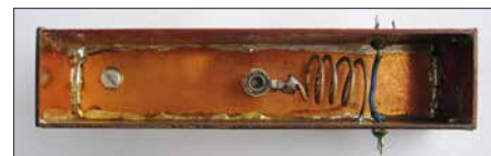
Bild 8: Saugkreis mit einem Gehäuse aus Leiterplattenmaterial
