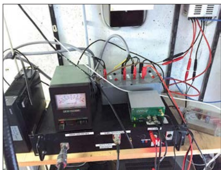
Die Indoor-Unit, bestehend aus Fernsteuerung, 9-cm-Bake, GPS-Empfänger, Steuerempfänger und Rotorsteuerung Fotos: DC7YS
