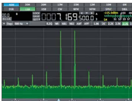
Bild 11: Intermodulationsprodukte eines Zweitonsignals ohne Dithering
