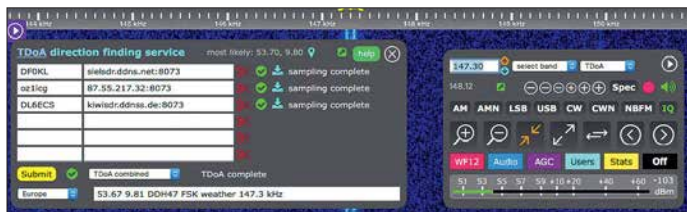
Bild 2: HF-Peilung eines STANAG4285-Datensignals auf 12 666,5 kHz mit drei Hyperbeln: Im Schnittpunkt liegt der gesuchte Standort nahe bei Toulouse. Grafik: FA
