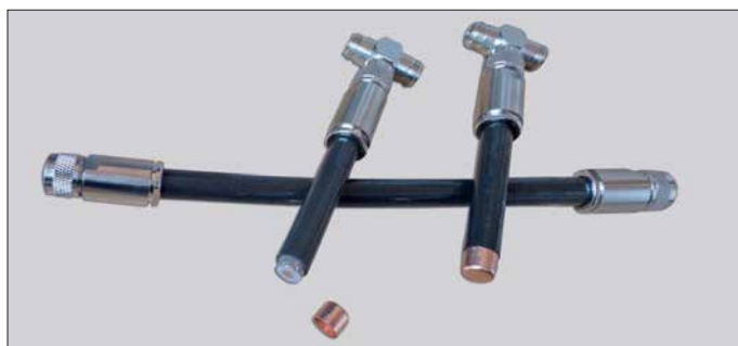
Bild 1: Praktische Realisierung des kombinierten 2-m-Tiefpass- und 70-cm-Notch-Filters mit Ecoflex15 und hochwertigen lötfreien N-Steckern und N-T-Stücken
