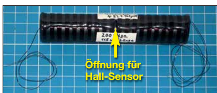
Bild 6: Die zur Kalibrierung verwendete Zylinderspule wurde auf ein Kunststoffrohr mit 22 mm Durchmesser gewickelt.
