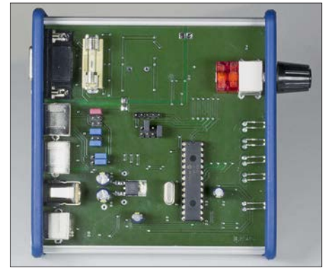
Bild 4: Bei abgenommener Gehäuseoberschale sind die Konfigurationsjumper und die Feinsicherung des Relaisstromkreises zugänglich. Die meisten Bauelemente befinden sich auf der Unterseite der Platine.
