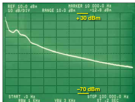
Bild 2: Spektrum des Fernost-Lüfters ohne X-Kondensator (externe Dämpfung: 20 dB)
