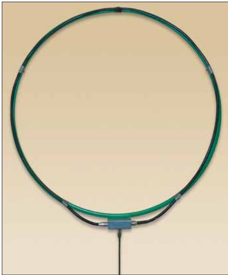
Bild 1: Ansicht der abgeschirmten Magnetic Loop; als Stützgerüst findet ein grüner Hula-Hoop-Reifen Verwendung. Der Außenschirm des Koaxialkabels ist oben auf 10 mm Breite unterbrochen.
