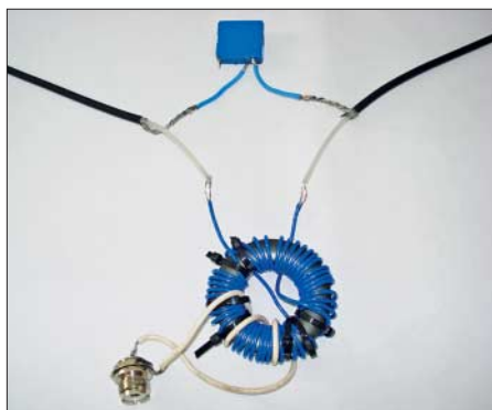
Bild 4: Zentraler Umschaltmechanismus mit Anpassübertrager als Versuchsaufbau; oben das Relais
