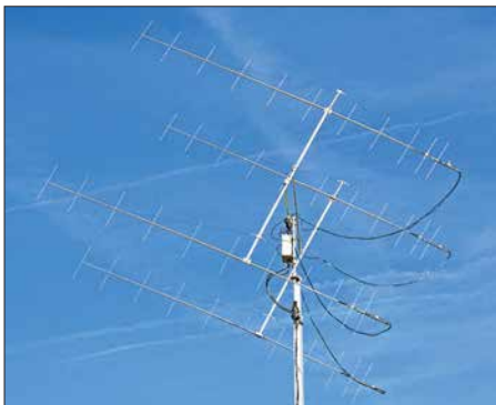
Mit seinen vier 11/11-Element-Kruzyagi-Antennen ist DK5YA auch bei EME gut präpariert: Polarisationsdrehungen des empfangenen Signals behindern nicht, wenn man in beiden Ebenen empfangen und senden kann. Foto: DK5YA
