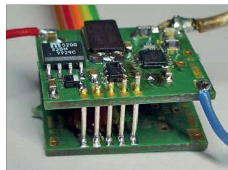
Bild 7: Kontaktierung des Programmieradapters mit der Bakensenderplatine
