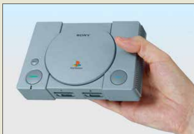
Das Gehäuse der PlayStation Classic wurde um fast die Hälfte gegenüber dem Original verkleinert.
