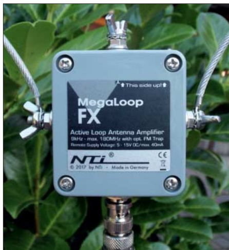
Bild 2: Speisepunkt (Verstärkergehäuse) der MegaLoop FX an der unteren Spitze der bei mir als Dreieck ausgeführten Schleife
