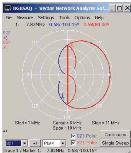
Bild 5: Polardarstellung von S_{21} bzw. E_{21} ; man erkennt, dass E_{21} teilweise um exakt 180^\circ gegen S_{21} phasenverschoben ist (Marker 1).
