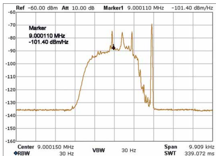
Bild 17: Seitenbandrauschen des Quarzoszillators an der Messgrenze des Spektrumanalysators; dessen Noise-Marker -Funktion zeigt den Wert -157,1 \text{ dBm/Hz} .
