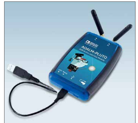
Bild 2: Der Adalm-Pluto , ein Lern- und Entwicklungssystem im optisch ansprechenden Gehäuse, ist sogar mit je einer Antenne für Senden und Empfang ausgerüstet.
