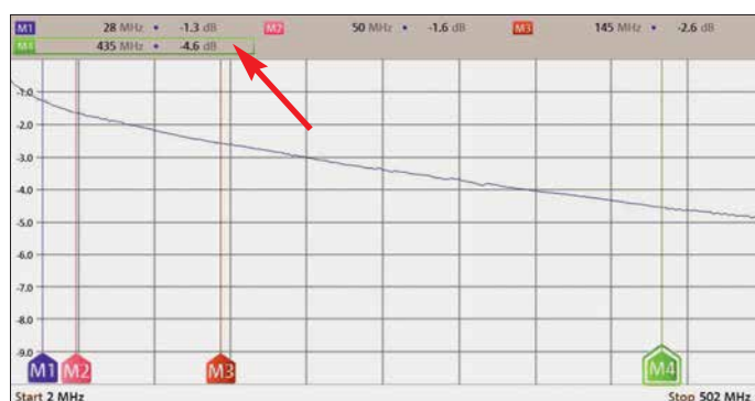
Bild 5: Dämpfungsverlauf von 23 m Kabel des Typs Belden Low Loss H155 PVC zwischen 2 MHz und 502 MHz
