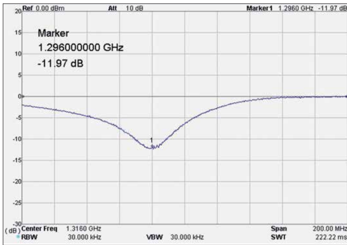
Bild 7: Nahselektion des Selektivverstärkers mit OFW-Filter
