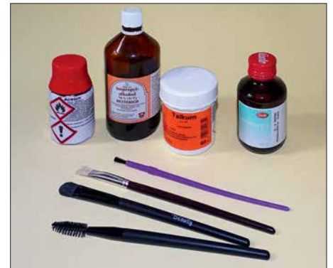
Die Gehäuse und Kabel werden zuerst mit Glycerin gereinigt und anschließend mit Talkum „beschichtet“.
