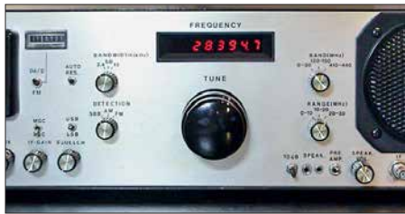
Bild 16: Analoger KW-Empfänger 0,1 MHz bis 30 MHz ohne Preselektor am Eingang und mit einem IP_3 = +26 dBm
