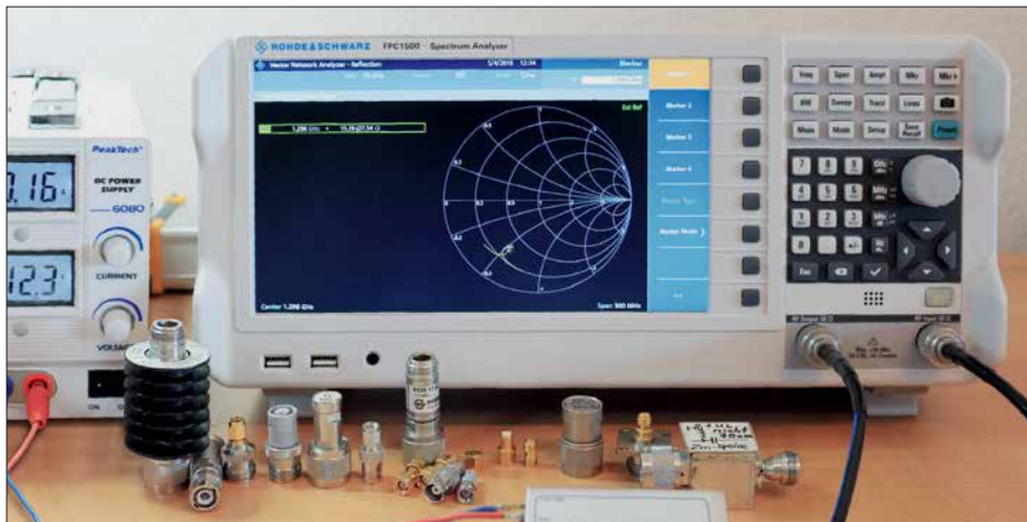
Bild 1: Spektrumanalysator FPC1500 von Rohde & Schwarz auf dem Messplatz; hier mit der aktivierten Ein-Port-VNA-Funktion, die eine Darstellung des Impedanzverlaufs im Smith-Diagramm erlaubt. Foto und Screenshots: DL2EWN
