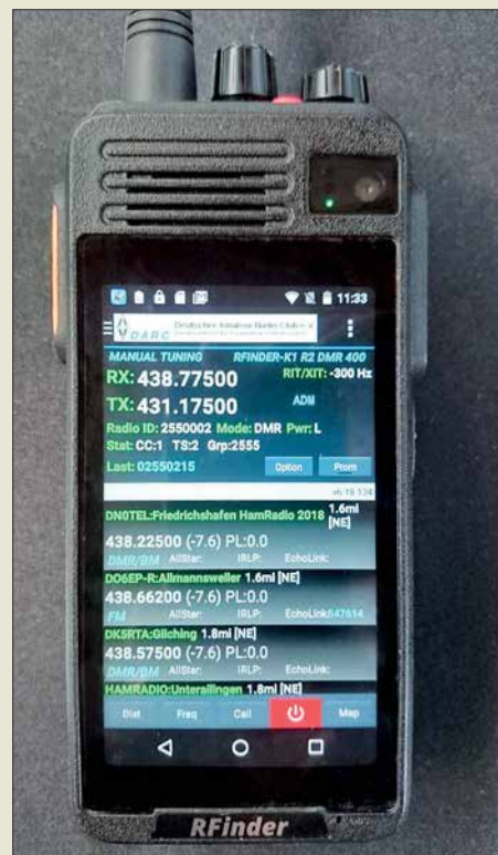
Der RFinder K1 (684 € plus Versand) ist ein von Runbo in China gefertigtes Handfunksprechgerät für 2 m oder 70 cm FM und DMR mit einem integrierten LTE-Android-Smartphone. Dank W2CYKs Repeater-App RFinder entfällt ein Hantieren mit Codeplugs.
