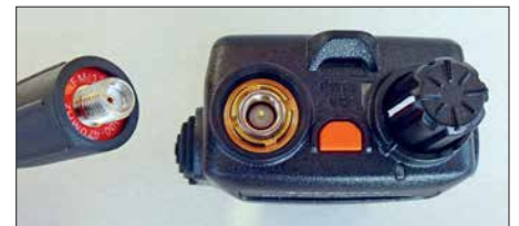
Die Antennenbuchse ist versenkt und wie heute üblich in Reverse-SMA-Norm ausgeführt.
