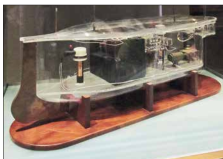
Diese Replika des Modellboots von 1898 ist voll funktionsfähig und kann mit dem danebenstehenden Tesla-Transformator ferngesteuert werden.
