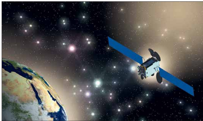
Bild 1: Es'hail-2 wird zum ersten Mal zwei Amateurfunk-Transponder als Ergebnis der Zusammenarbeit der Qatar Satellite Company, der katarischen Amateurfunkvereinigung QARS und der AMSAT-DL in einen geostationären Orbit (Phase-4A) tragen.
