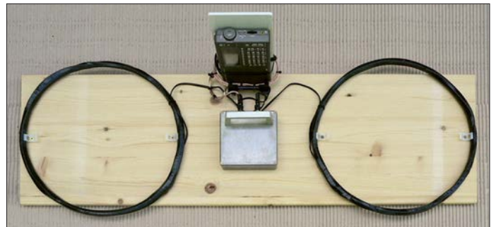
Bild 2: Versuchsanordnung Variante 2 – Vorsatz für Empfänger mit interner Ferritantenne; weitere Bilder dieser Variante finden sich in der Ergänzung.
