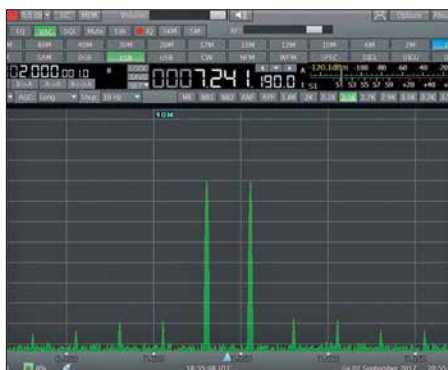
Bild 28: Das entsprechende Messergebnis bei P_e = 2 \cdot (-40 \text{ dBm}) zeigt \Delta IM_3 = 68 \text{ dB} und IM_3 = -6 \text{ dBm} .
