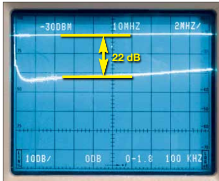
Bild 7: Eingangsreflexionsdämpfung bis 20 MHz; S_{11} = 22 dB ( s = 1,17 ) bei 9 MHz
